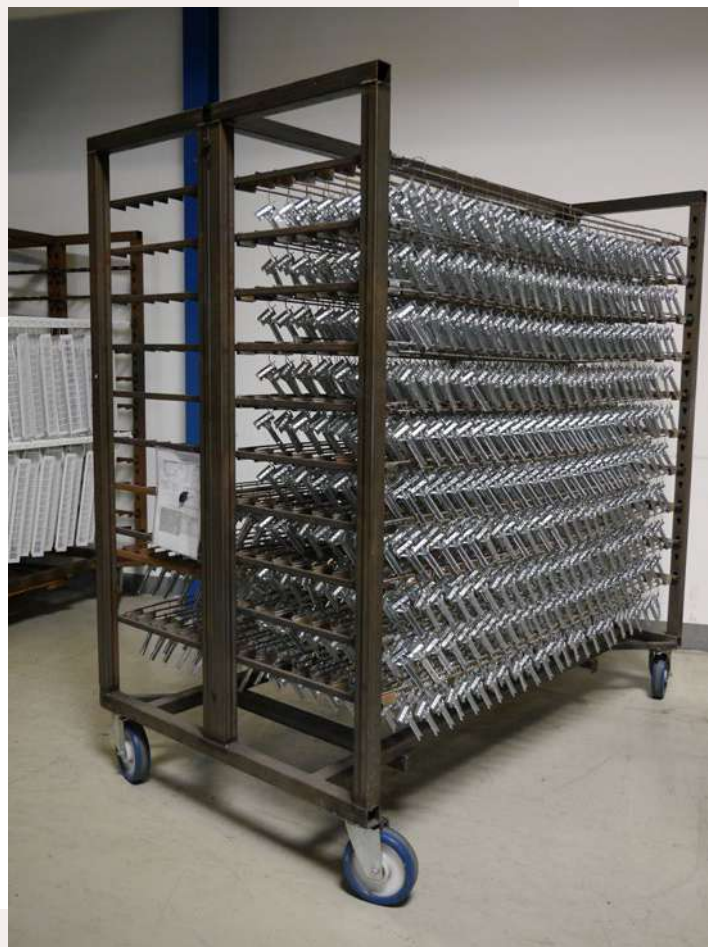
Přepravní a skladovací vozík pro lakovací příčnický.
