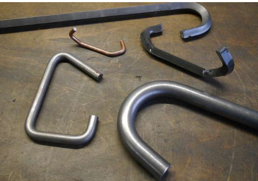
Ohýbané díly ze čtvercového a kulatého materiálu o průměru 8 až 30 mm.
