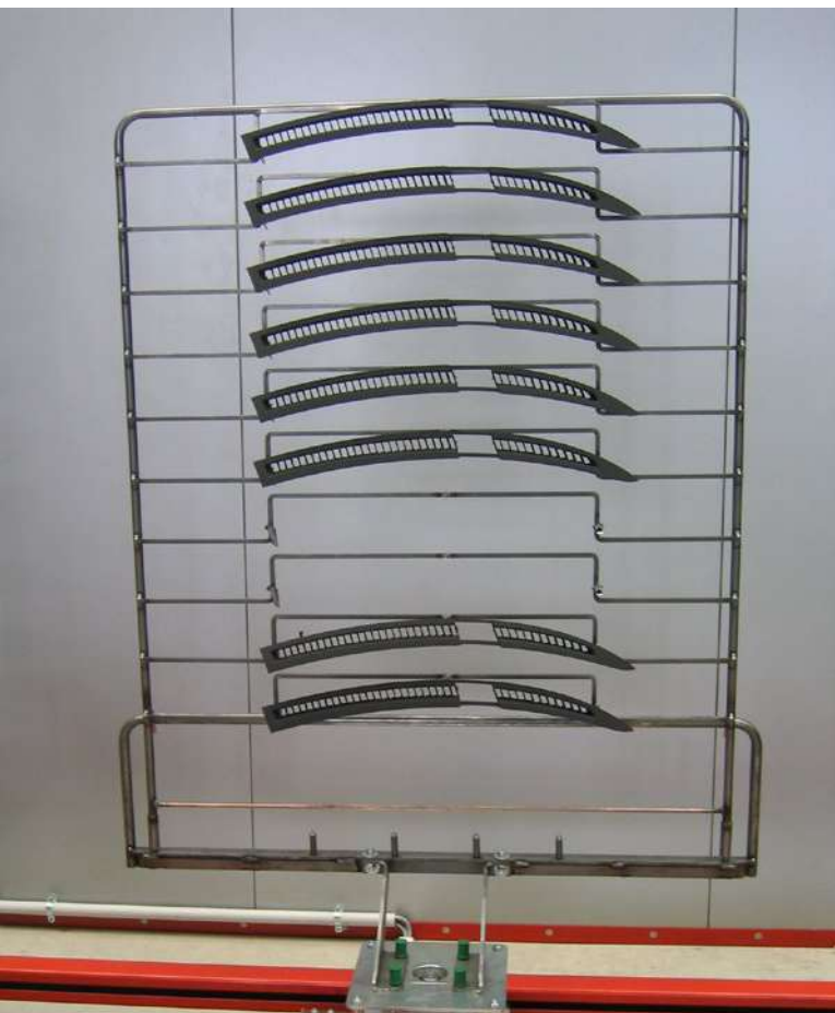
Lakovací stojan pro podlahový dopravník. Plastová mřížka je na místě uchycena drátěnými držáky a dvěma upínacími pružinami.
