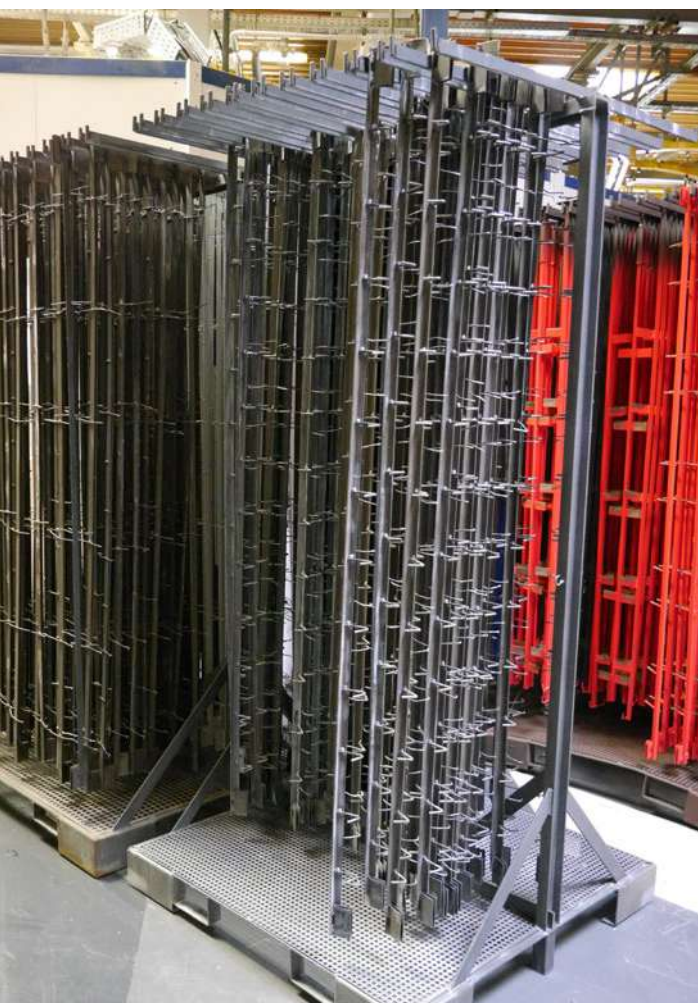
Stojan na odstraňování nátěrů vhodný pro individuální zákaznické lakování.
