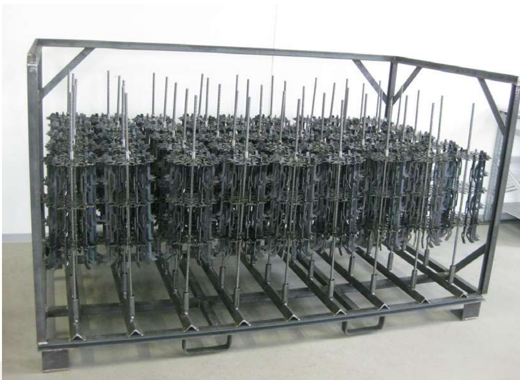
Transportní a skladovací vozík pro lakovací závěsy s optimálním využitím prostoru.
