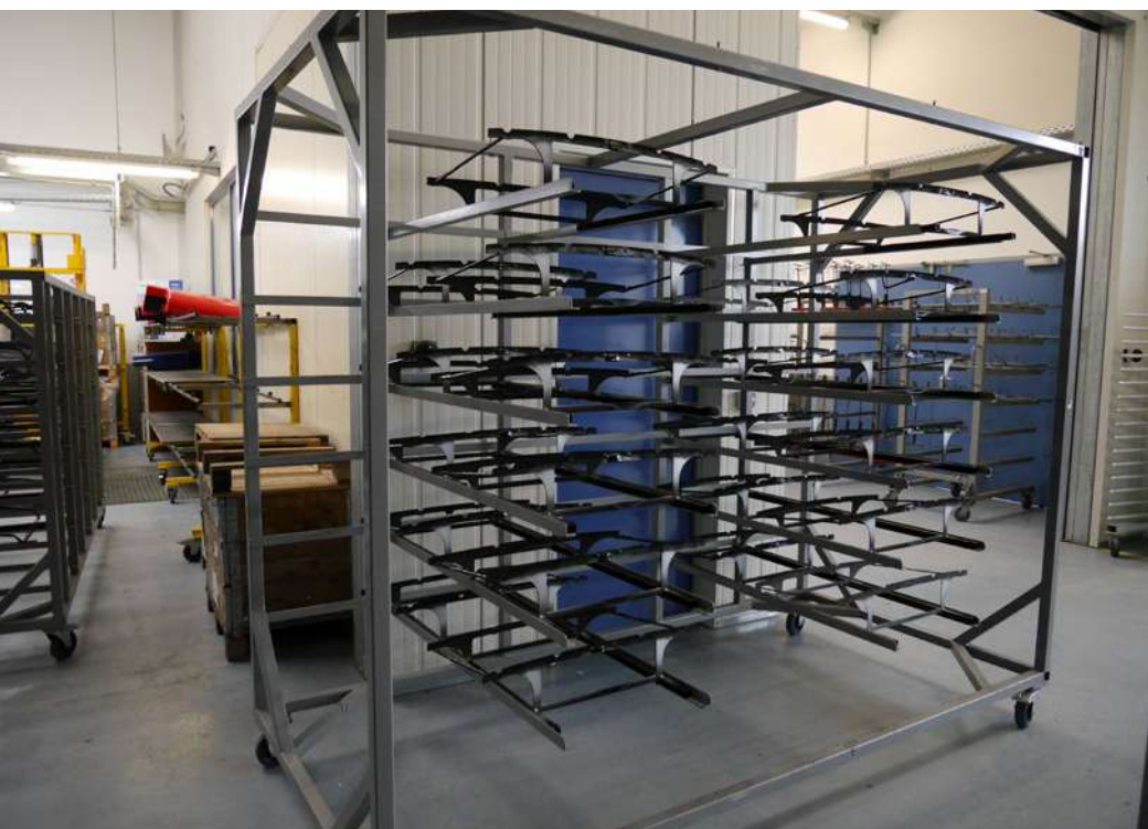
Skladovací a sušící vozík pro lakovací rošty.
