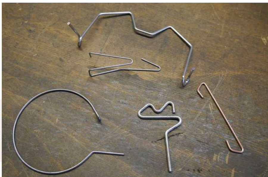
Dvourozměrné a trojrozměrné díly pro ohýbání drátu o průměru 1,5 až 3 mm.
