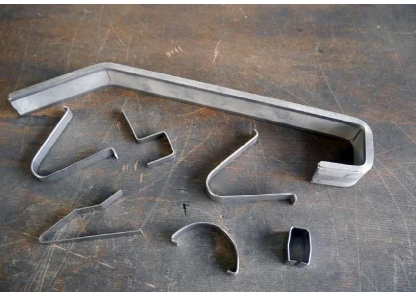
Pružinové svorky z pružinové oceli VA a závěsné háčky z plochého materiálu (30 x 8 mm).
