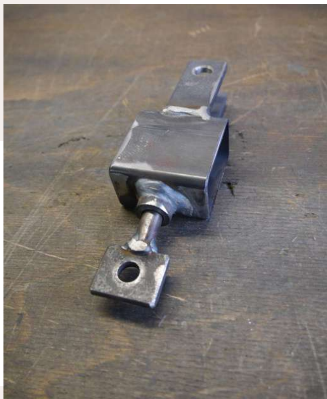
Otevřené otočné zařízení s aretací po 90°.
