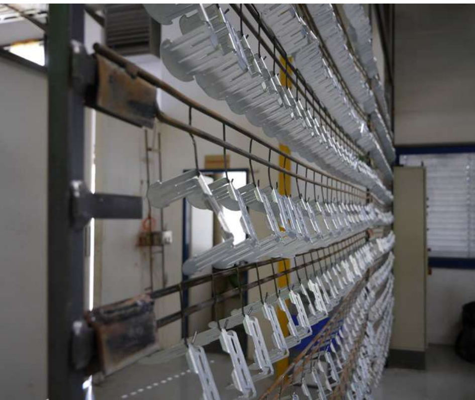
Příčný nosník na háčky pro univerzální uchycení různých plechových dílů.
